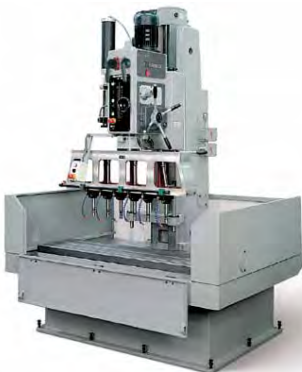
BP-50 con mesa extralarga de 400 x 1500 mm para taladrado de varillas con cabezal múltiple de husillos ajustables en línea.
