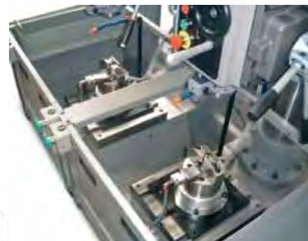
Detalle de útiles de amarre autocentrantes hidráulicos de rótulas de automoción.
