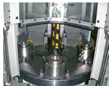
Detalle de mesa giratoria de 4 posiciones para batería circular con útiles de amarre hidráulicos sincronizados.
