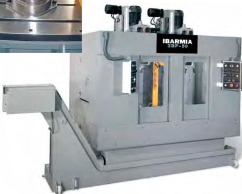
Batería de 2 cabezales con carenado total, apertura automática de puertas, separador de zonas de trabajo, útiles de amarre sincronizados, extractor automático de virutas y paneles de mando exteriores.
