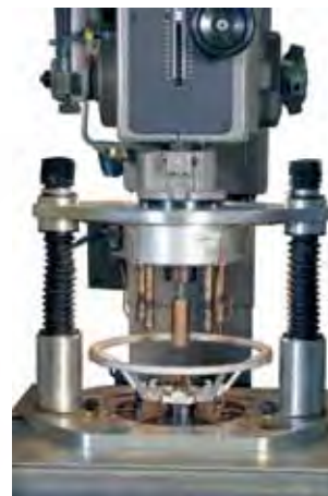
Detalle de taladrado con cabezal múltiple de volantes de conducción de automóviles.
