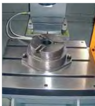
Plato autocentrante neumático de 3 garras, con ciclo de apertura/cierre sincronizado.
