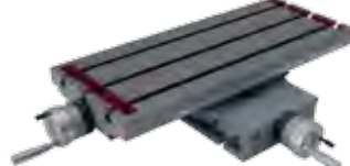
MB3 Mesa de coordenadas por husillos. X = 400 mm. Y = 180 mm. Peso neto mesa = 52 kg. Disponible para series Z/X(32-34) .
