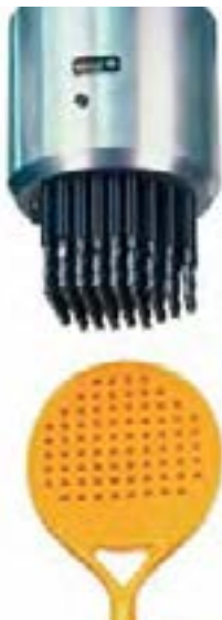
Aplicación de taladrado simultáneo de 76 orificios en paleta de paddle.
