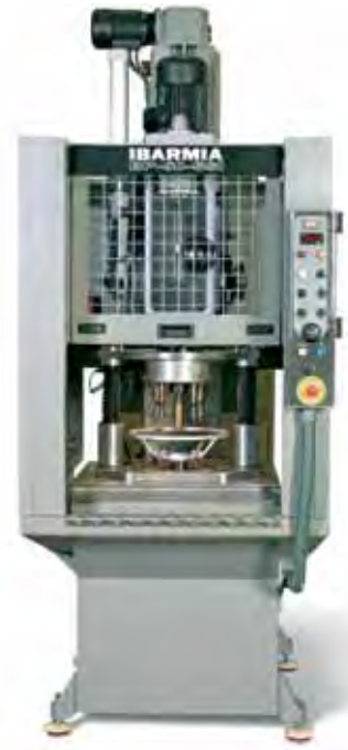
Unidad de taladrado con cabezal múltiple de volantes de conducción para sector de automoción, bajo rigurosas normas técnicas y de seguridad del cliente.
