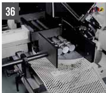
SHARK 332 NC 5.0 - Dispositivo para cortes en manojos y guía regulable para descarga de piezas (máx. 240X90)
