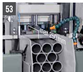
53 SHARK 230 NC HS 5.0 - Mordazas verticales hidráulicas para cortes en manojos (máx 230x230 mm)
