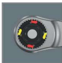
Dentado de trinquete doble, ángulo de retorno de 5° máx.
