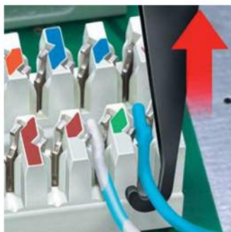
Con gancho tractor integrado
