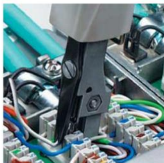
Corta y presiona en una sola operación
