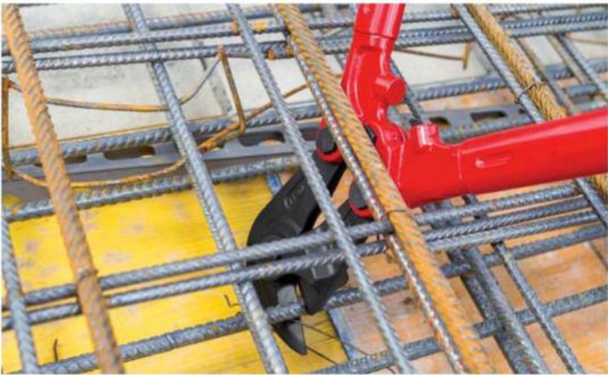
El formato especial del cortante para varilla de encofrado 71 82 950 permite el corte de aceros de construcción situados en plano
