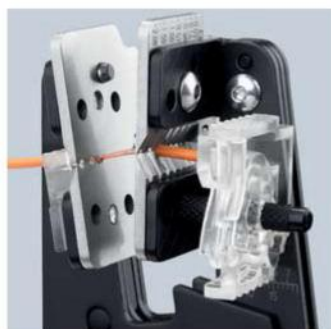
Precisión de pelado gracias a la forma de sus cuchillas
