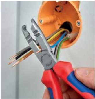
Realizar cortes al acortar conductores individuales
