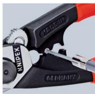
Prensar el terminal al cable de tracción
