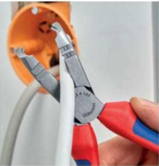
Corta cables con diámetros de hasta 13 mm
