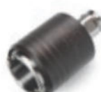
PORTABROCAS DE CAMBIO RÁPIDO PARA ROSCADORAS TAM. 3 CON ALOJAMIENTO QUICKIN MAX/WELDON 32 Solo puede utilizarse para máquinas perforadoras con imán con función de giro a izquierda. Para roscadoras según DIN 374/376, en combinación con insertos roscados con o sin acoplamiento de seguridad de M22-M36.
