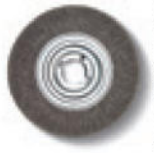
CEPILLO DE ACERO Ø 250 mm x 60 mm, con resistencia nominal muy elevada para un uso especialmente rentable, taladro de alojamiento Ø 51 mm. 0,2 mm de grosor de alambre para tubos y perfiles de paredes finas. 0,35 mm de grosor de alambre para todo tipo de aplicaciones. 0,5 mm de grosor de alambre para tubos y perfiles de paredes gruesas y una elevada potencia de desbarbado. Modelo de acero
