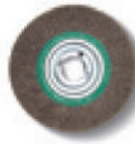
CEPILLO DE ACERO Ø 250 mm x 60 mm, con resistencia nominal muy elevada para un uso especialmente rentable, taladro de alojamiento Ø 51 mm. 0,2 mm de grosor de alambre para tubos y perfiles de paredes finas. 0,35 mm de grosor de alambre para todo tipo de aplicaciones. 0,5 mm de grosor de alambre para tubos y perfiles de paredes gruesas y una elevada potencia de desbarbado. Modelo de acero inoxidable
