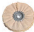
CILINDRO ONDULADO DE FIELTRO Para el pulido y el pulido previo de acero inoxidable. Gracias a los listones, el fieltro no se «quema» y puede pulirse sin que se formen tiras. Utilizar solo con pasta de pulir (pulido previo = pasta de pulido previo, abrillantado = pasta de abrillantado).
