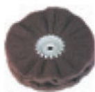
TELA DE PULIR con pliegues, ancho de aprox. 30 mm, taladro de 14 mm, para ligeros trabajos de desbarbado, desoxidación, ligeros trabajos de lijado, trabajos decorativos
