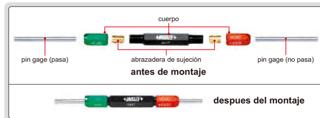
abrazadera de sujeción Cobre (0.2-7.14mm) Aluminio (7.14-25.65mm)
