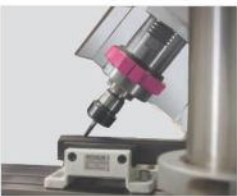
Cabezal · Inclinación lateral ±45°.
