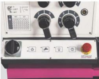
Panel de control · Membrana de fácil manejo. · Teclado con funciones: máquina encendida, bomba de luz y marcha directa.
