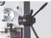
Avance manual y husillo con ajuste fino · Volante de mano. · Fácil de operar.
