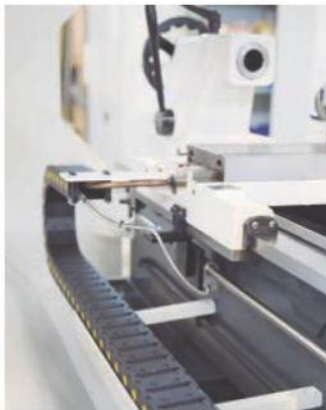
Cadena energética (TH 4615D - 4620D) · Para un tendido cuidadoso de cables y mangueras.
