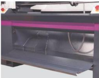
Cajón para virutas · Extensible. · Fácil limpieza de virutas desde el frontal.
