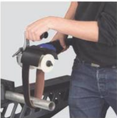
Para satinado de tubos de acero con tela de pulir o también, por ejemplo, para barandillas de acero inoxidable.
