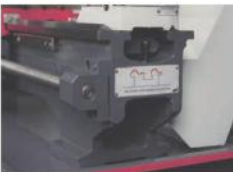
Bancada · De fundición gris, endurecida y templada por inducción, rectificado de precisión.
