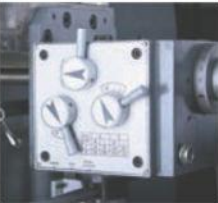
Avance de la mesa · Automático. · Avance de la mesa en eje X.
