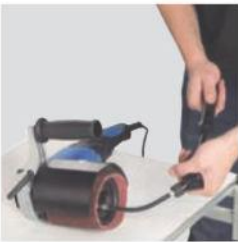
Fácil ajuste del cilindro de lijar al bombear el rodillo de goma.
