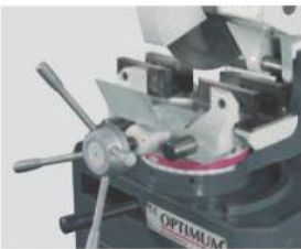
Mordaza · Autocentrante. · Garras ajustables individualmente. · El corte se efectúa siempre en la posición óptima para la pieza. · Eje de la mordaza protegido.
