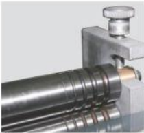
· Curvado y enrollado de alambres, tubos y láminas de metal Ø 1-2-3-4-5 mm.
