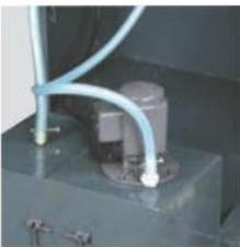
Sistema de refrigeración · Integrado. · Capacidad de 8 l.
