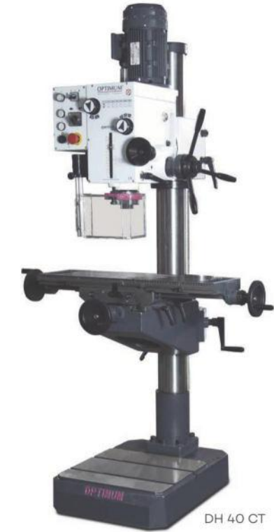
Cabezal · Inclinación lateral ±45°.
