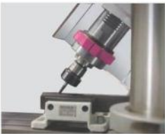
Cabezal · Inclinación lateral ±45°.
