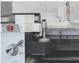
Avance plano y longitudinal · Avance rápido - pulsador y palanca para activar y desactivar movimiento rápido en sentido transversal y longitudinal para trabajo aún más racional. · No desconecta toda la máquina al llegar al final de carrera.
